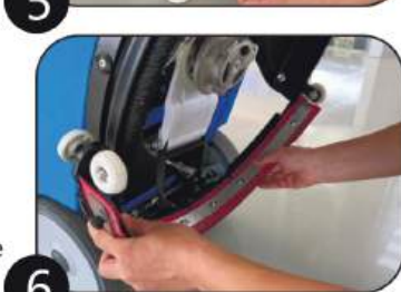
3 Отсоедините рукав всасывающего шланга от скребка; Снимите скребок с крепления, полностью открутив две ручки
